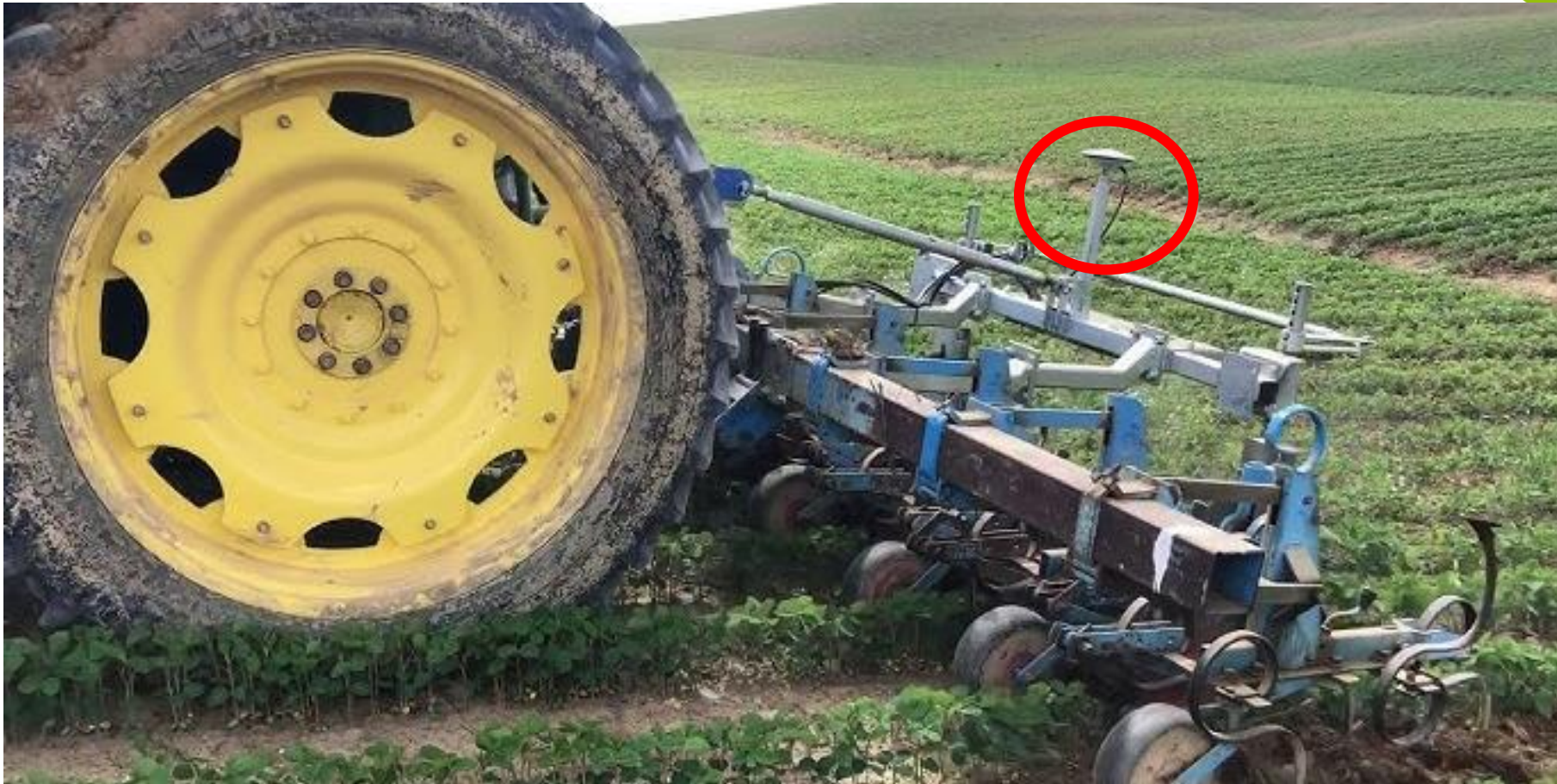
Agrotronix : Bineuse à tournesol et soja 8 rangs guidée par RTK
